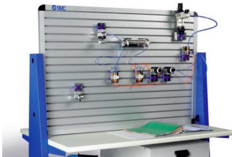
Rys. 2. Tablica montażowa systemu Pneutrainer
